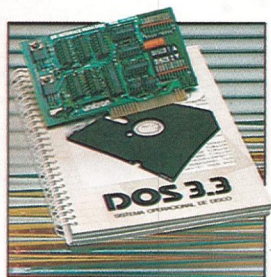
D II: Interface controladora para até duas unidades de disco flexível de 5 1/4".
